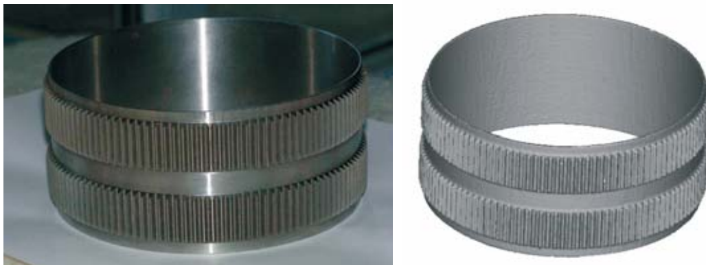
Rys. 10. Koło podatne przekładni falowej: obiekt rzeczywisty, oraz wygenerowany model STL
