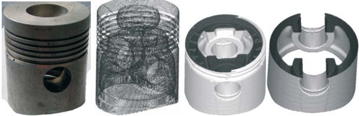
Rys. 8. Tłok silnika spalinowego-wysokoprężnego samochodu ciężarowego (kolejno): obiekt rzeczywisty, model konturowy, model STL - przekrój, (dobrze widoczna budowa wewnętrzna badanego elementu)
